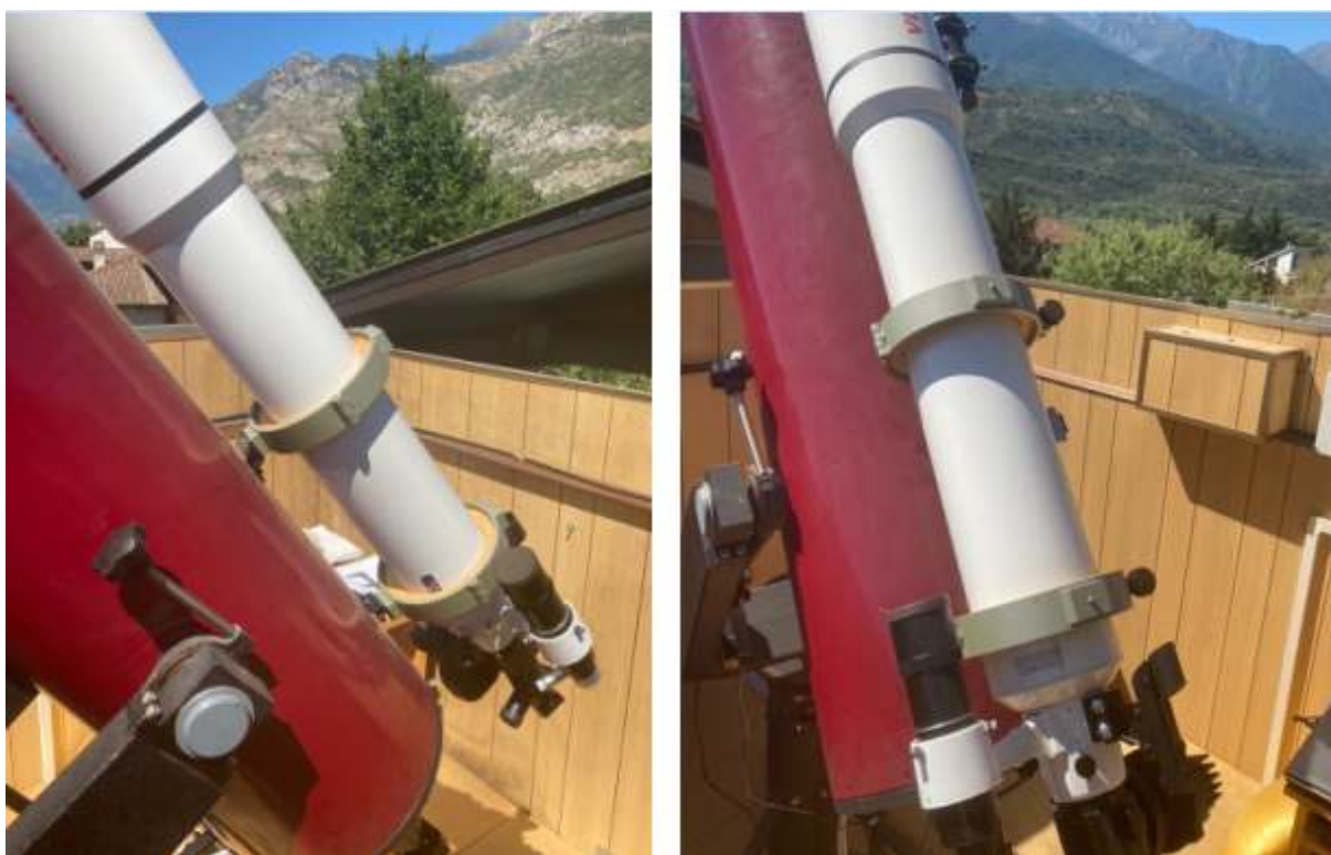
Vista della strumentazione nella specola del Grange Observatory, con il telescopio riflettore di 30 cm con il tubo isolante di bachelite, ed il tubo bianco del rifrattore di 140 mm con le sue camere professionali per fare fotometria ed astrometria a grande campo (33x33 e 101x67 arcominuti)
